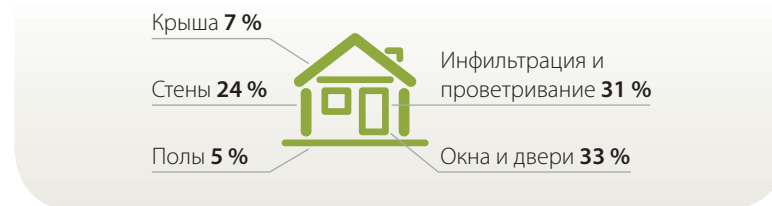
Рис. 8. Распределение тепловых потерь в здании
